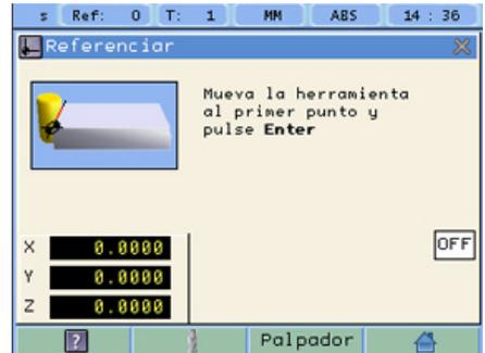
**[Eje Z]** Activar el referenciado del eje Z.
